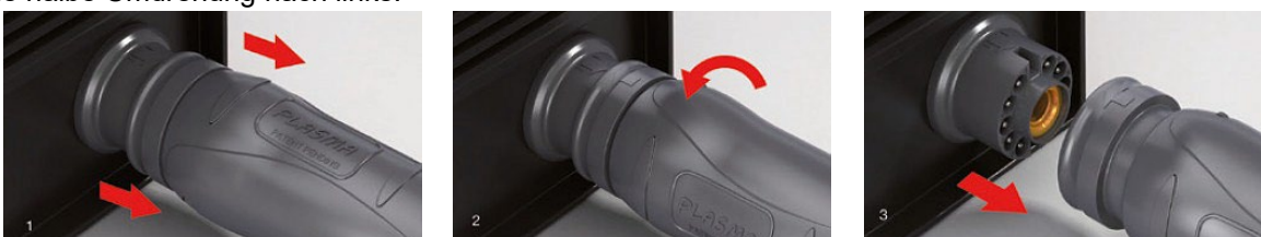
Abb. 4-2: Anschluss des Brenners lösen
