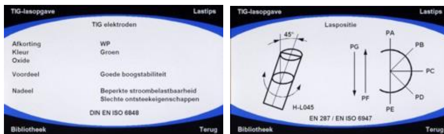
Fig. 42: Bedieningspaneel INVERTIG.PRO digital weergave bibliotheek: TIG-elektroden en Lasposities
