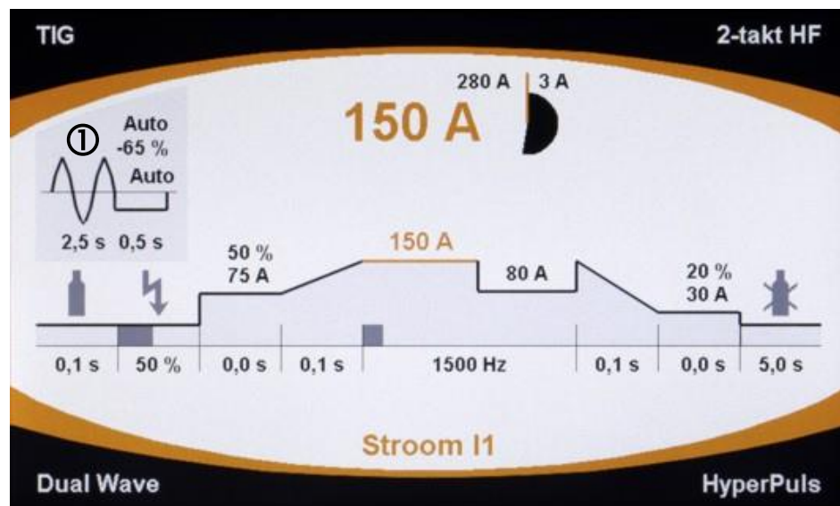
Fig. 20: Bedieningspaneel INVERTIG.PRO digital: applicatie Classic. ① Grafische afbeelding linksboven, beeld van de AC-frequentie (Auto), AC Balans (65%), AC curvevorm, tijd Dual Wave AC en DC (2,5 s en 0,5 s).
