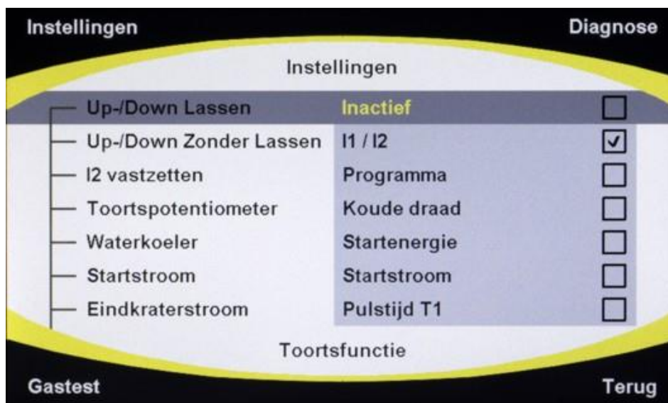
Fig. 44: Bedieningspaneel INVERTIG.PRO digital Applicatie System: overzicht met pull down menu
