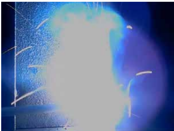
Hoher Strom = Einbrand
