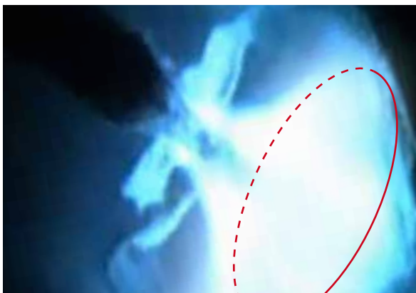
Bisher: Konventioneller Schweißprozess Breiter Lichtbogen mit Energie an den Rändern
