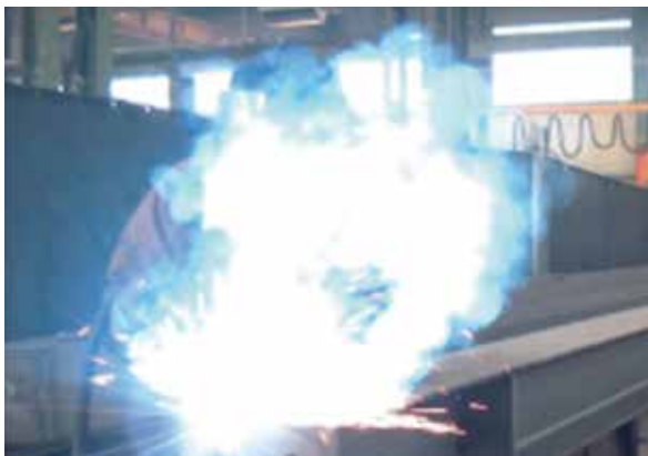
Bisher: Hohe Schweißrauchentwicklung im konventionellen Schweißprozess.
