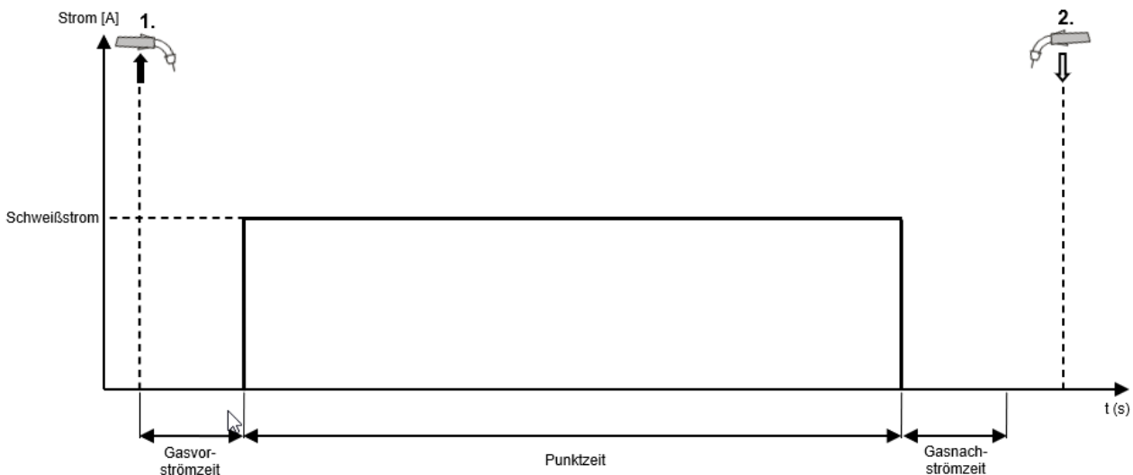
Figura 19: Sequenza della modalità operativa Puntatura
