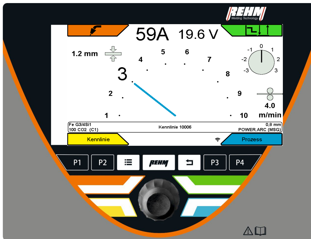
Figura 8: Elementi di comando e schermata principale SYNERGIC.ARC
