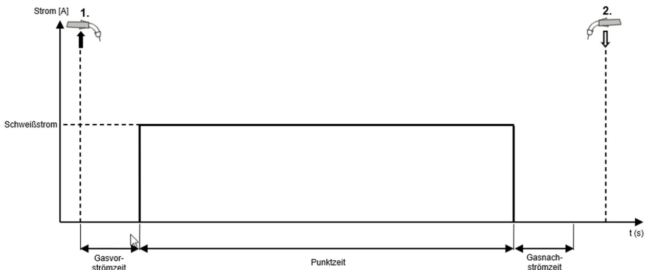
Afbeelding 19: Verloop van de bedrijfsmodus puntlassen:
